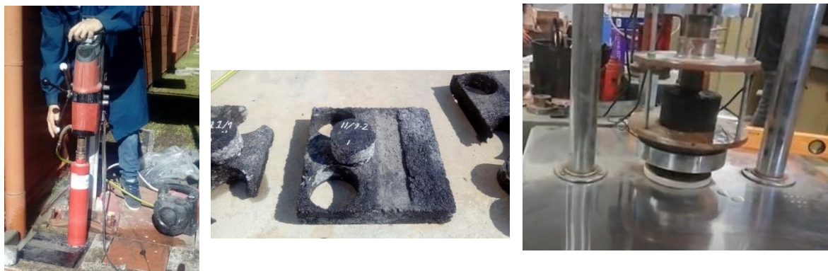
Figura 9 vista de las extracciones de testigos y ensayo de punzonado
